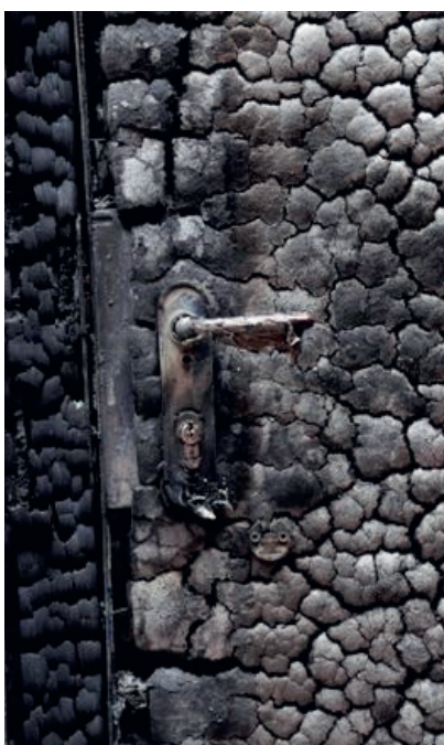
Abb. 3 KfV-Hauptschloss mit FS-Falle nach der Brandprüfung
