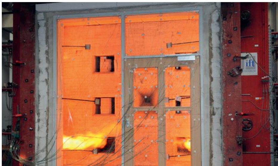
Abb. 1: Start einer Brandschutzprüfung im ift Rosenheim
